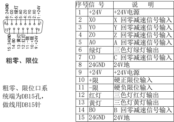
图 4.7-1 粗零、限位、三色灯口开关量输出、输入内部原理如图 4.7-2；
